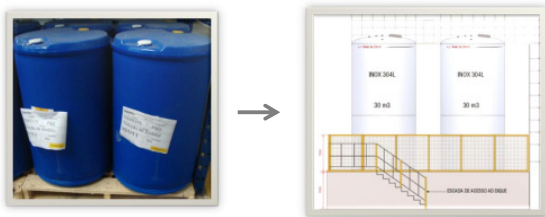
Figura1: Embalagem atual de material, Tambores de 280Kg, e nova forma de armazenamento proposta, Tanques de 24m 3
